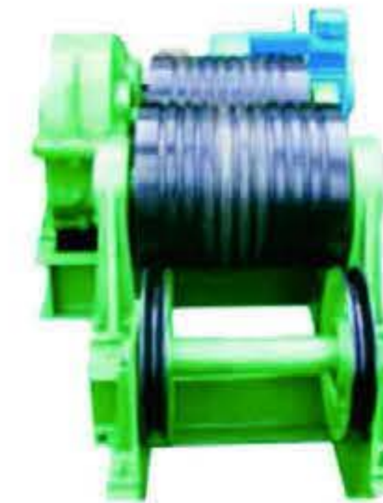
为衡阳钢铁公司废钢回炉生产线 (轨道距离300m,重量260吨) 配套JK5摩擦 式卷扬机, P=50KN, V=40m/min 其结构 特点: 单机实现自动循环, 即生产线运行由 一台设备完成。
